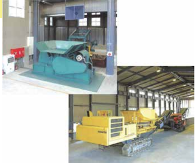
建築廃材を2回破砕し、建築廃材と一般廃材に分けます
