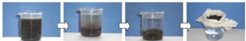
処理前汚泥水 MSC添加 高分子凝集剤添加 処理脱水後
