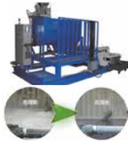
乳化した食堂排水処理
